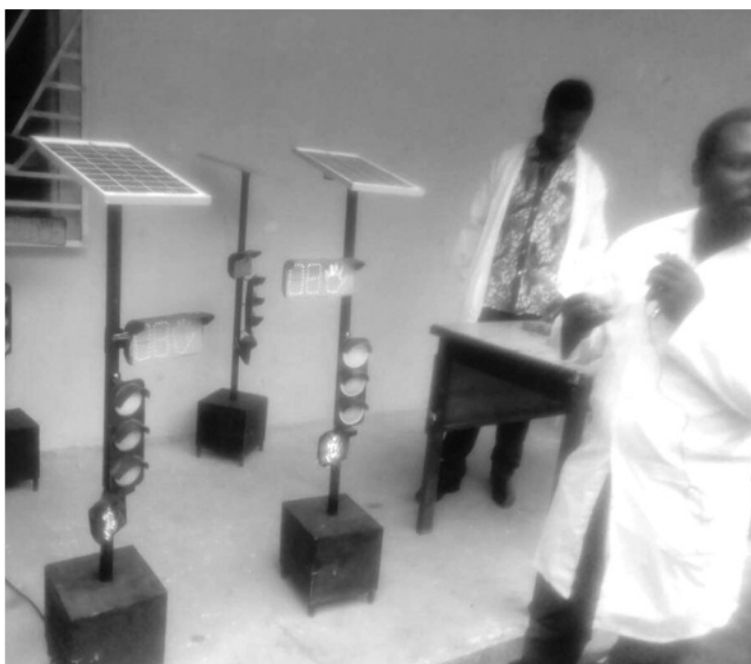
Des feux de signalisation à panneaux solaires. Innovation de l'Université de Ngaoundere.
