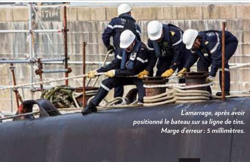
*L'amarrage, après avoir positionné le bateau sur sa ligne de tins. Marge d'erreur : 5 millimètres.*
